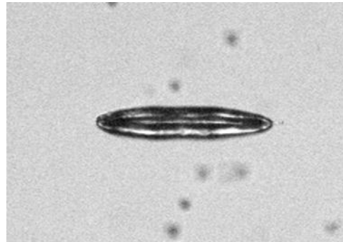
Σχήμα 4.11 Αρχικό σχήμα Φυσαλίδας Ενέργειας 38 \mu J
